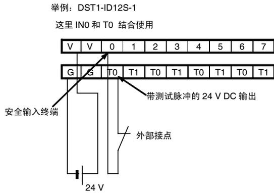
当外部输入接点转为 ON 时，来自测试输出终端的测试脉冲诊断内部回路。使用这个功能，输入信号线和电源（正极）之间的短路，输入信号线之间的短路都能被检测到。
