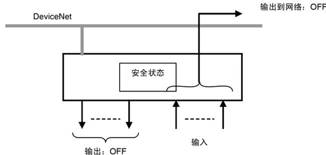
所以，DST1 系列安全输入输出终端可以被应用于当安全输出为转为 OFF、到网络的输出数据转为 OFF 的场合，此时 DST1 系列安全输入输出终端进入安全状态。
