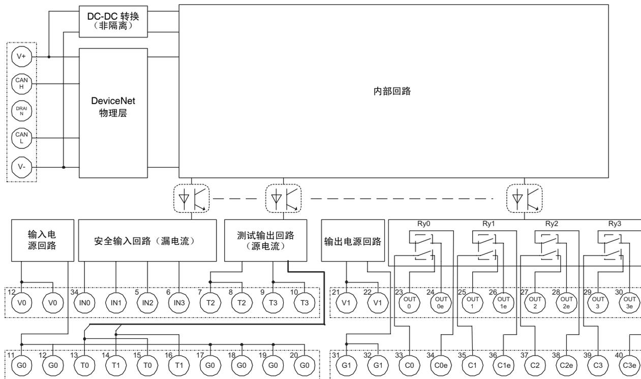
以下图形说明了 DST1-MRD08SL-1 接线端子的端子排列。
