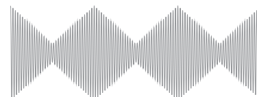
變頻器2次側漏電電流波形示意圖 電流值反覆增減。
