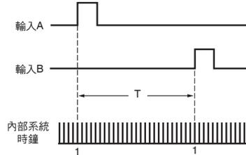
在內部系統時鐘，計算輸入A的脈衝到輸入B的脈衝的時間（T）。假設T之間的系統時鐘的計數為100000時，
