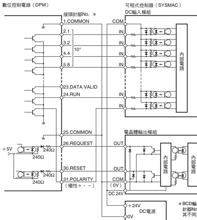
\* BCD輸出的接頭針腳No.，即為連接另售的BCD輸出專用纜線時的D-Sub接頭之針腳No.。其不同於本體的小間距接頭（本多通信工業製）之針腳No.。
