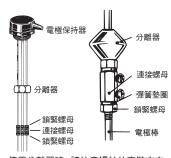
註. 使用分離器時,請注意螺絲的安裝方向, 避免連接螺母的螺絲碰撞到其他電極棒 連接螺母的螺絲。
