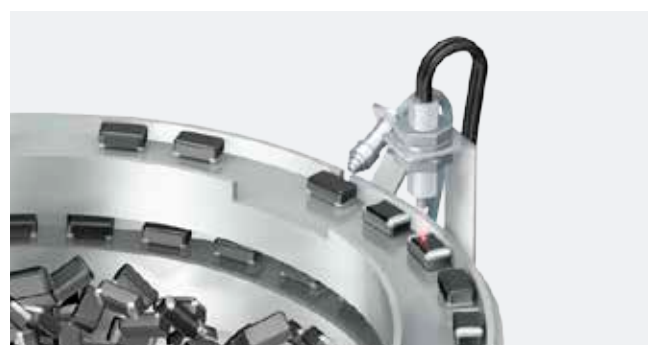
輸出晶片正反面檢測時的空氣吹出
