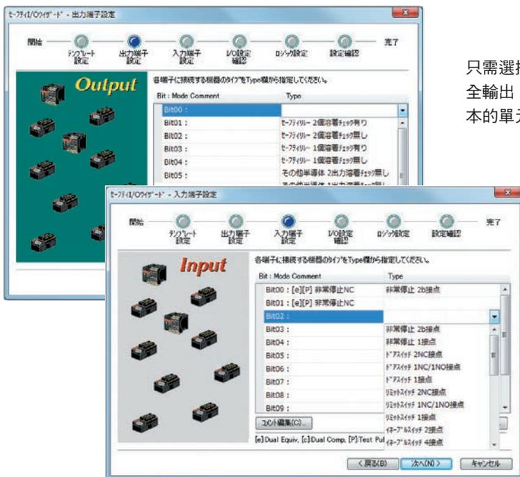
只需選擇緊急停止開關2b接點型等的安全輸出、輸入元件（方案）即可完成基本的單元設定
