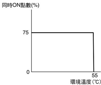
擴充I/O模組（CP1W-8ER/16ER/20EDR1/32ER/40EDR型）和CPU模組搭配使用時，環境溫度會限制電源電壓和輸出負載電流。請在以下的電源電壓和輸出負載電流的範圍內使用。
