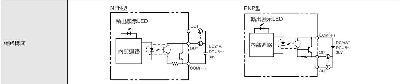
註1. 請勿對輸出端子施加超過最大開關容量的電壓，或連接超過最大開關容量的負載。
